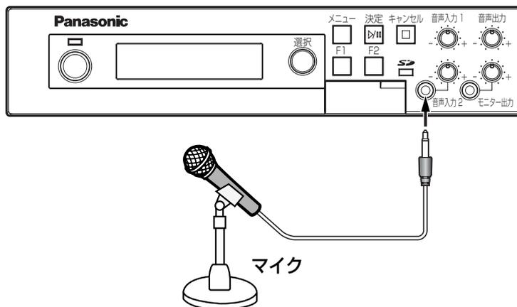
デジタルICレコーダー（WZ-DP250）にマイクロホンを接続し、「高音質モード」で録音します。録音ソースがマイクロホン以外の場合も同様です。
