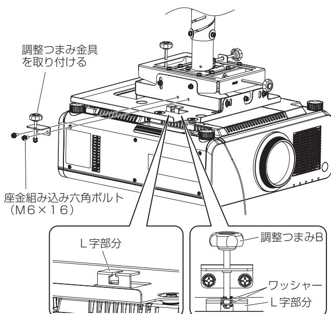
5) 調整つまみ金具のボルトを取付用ベース金具のL字部分にかけ、調整つまみ金具の金具部分を調整金具ユニットに付属の座金組み込みボルト（M6×16）2本で固定する。
