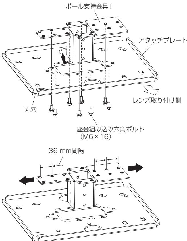
アタッチプレートの中央にポール支持金具 1 を差し込み、付属の座金組み込み六角ボルト (M6 × 16) 8 本で固定する。(アタッチプレートとポール支持金具 1 の向きは左図を参照ください)
