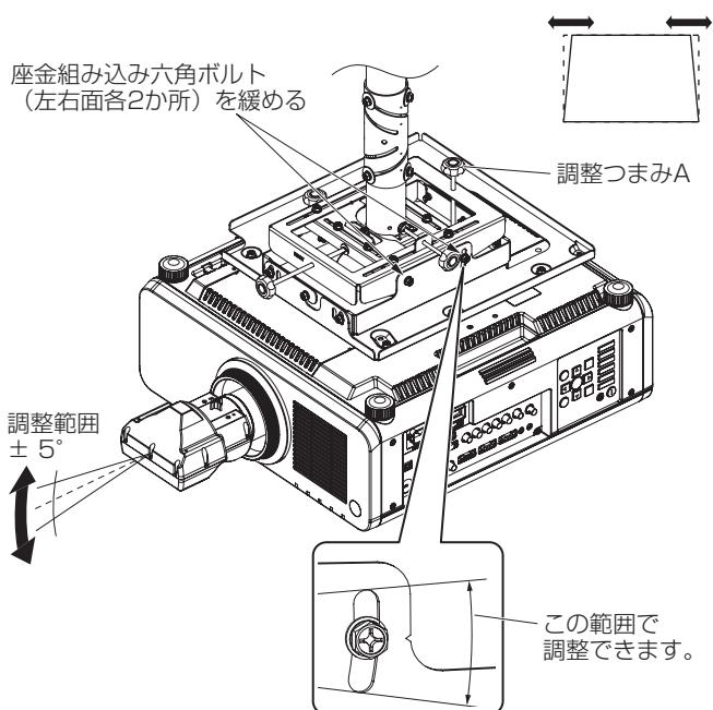
1) 左図のように調整金具ユニットの上下方向の傾きを固定している座金組み込み六角ボルト（左右面各2か所）を緩める。
