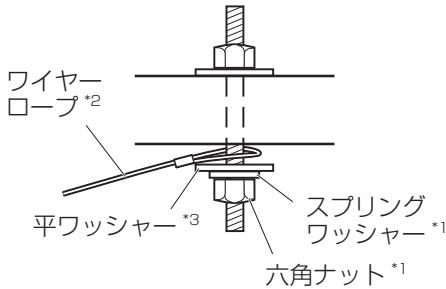
1) アンカーナットまたはカールプラグ (M8) を、しっかりとコンクリート天井 (左図の範囲内 1か所) に取り付ける。
