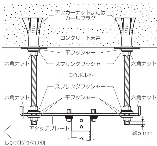
1) コンクリート天井にアンカーナットまたはカールプラグを取り付け、つりボルト4本をしっかりと固定する。(取り付け位置は10ページを参照してください)
