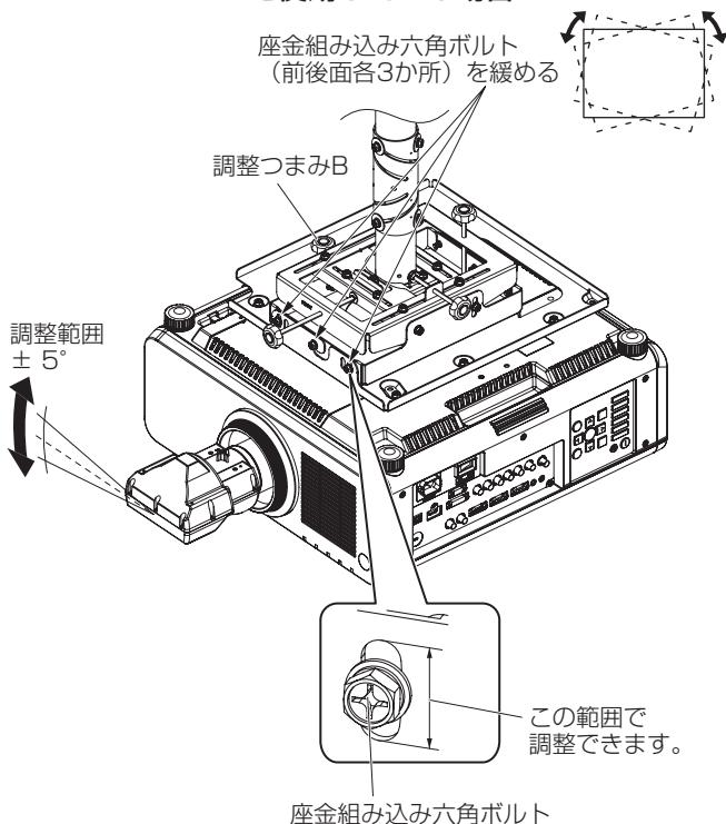
1) 取付用ベース金具を前後から固定している座金組み込み六角ボルト（前後面各3か所）を緩める。
