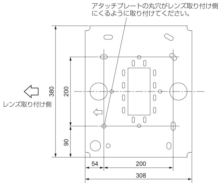
つりボルト取り付け穴寸法
