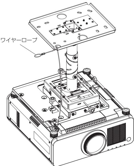
6) 左図のように、あらかじめプロジェクター本体に取り付けられているワイヤーロープをアタッチプレートの穴に通す。
