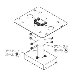
アジャストポール (A) にアジャストポール (B) を差し込み、穴の位置を合わせて付属の座金組み込み六角ボルト (M6 × 16) 6 本でしっかりと固定する。
