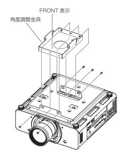
⑥ 角度調整金具を付属の座金組み込み六角ボルト (M6 × 16) 6 本で、プロジェクター取り付け金 具に固定する。
