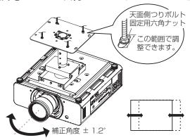
① アタッチプレートの天面側のつりボルト固定用六角ナット(4か所)を緩めて、プロジェクター本体を左右に動かして映像センターとスクリーンセンターが垂直線上で合うように調整する。
