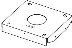
1個                                                              | 本金具を天井に、4本のつりボルトを介して取り付けます。取り付け方法には、コンクリートと木造天井の場合の2通りがあります。左右方向の調整機能があります。 |
