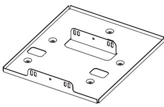
1個                                                              | 本金具にプロジェクター本体を取り付けます。左右傾きの調整機能があります。                                        |
