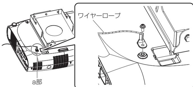
ワイヤーロープの先端の金具を付属の座金組み込みねじ（M4 × 12）1本で、プロジェクター本体のa部に固定する。
