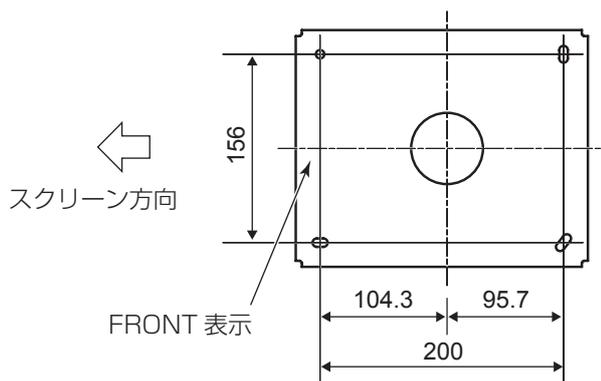
〈つりボルト取り付け穴寸法〉
