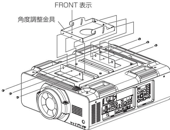
左図のように、付属の座金組み込み六角ボルト（M6 × 16）6 本で角度調整金具を取付用ベース金具に固定する。
