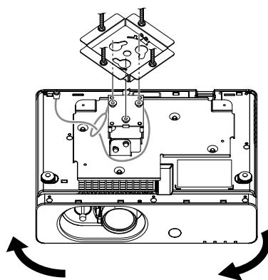
③ プロジェクターを左図の矢印の方向に回転させ、アタッチプレートの取付金具固定ねじを仮止めする。
