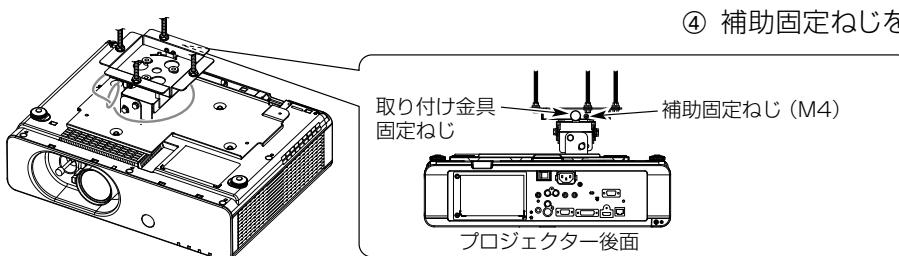
④ 補助固定ねじをトルクドライバーで固定する。
