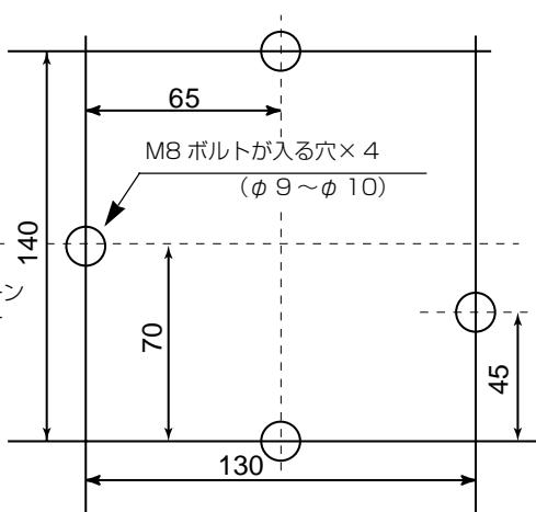
アタッチプレートの取り付け金具固定ねじがスクリーンの反対側に来るよう取り付けてください。
