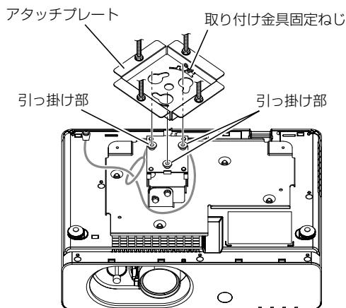
① アタッチプレートの取り付け金具固定ねじと補助固定ねじを緩める。
