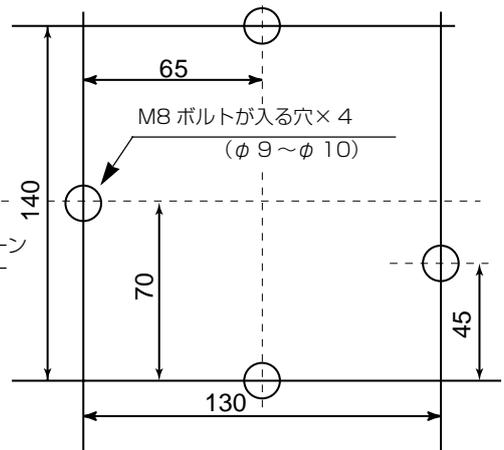
アタッチプレートの取り付け金具固定ねじがスクリーンの反対側に来るように取り付けてください。
