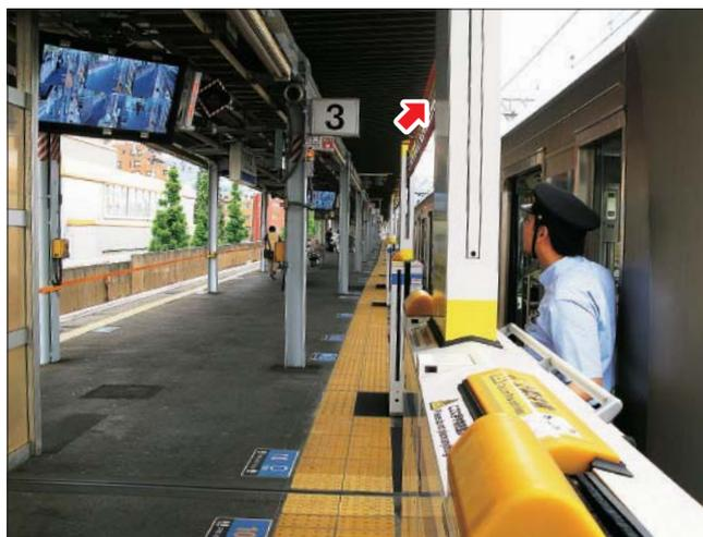
▲ホーム柵(赤色矢印)の上昇によって悪くなる前方の視界をディスプレイ映像(「車掌用ホームモニタ」(写真左上))で車掌が確認することで、安全な列車運行ができる。
