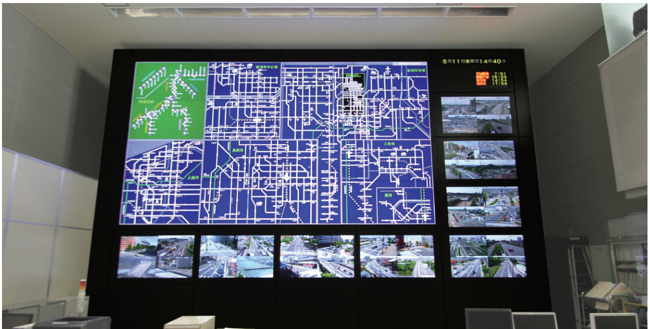
70型ワイドスクリーンを縦横それぞれ4面、計16面のマルチビジョン。監視カメラ用に周囲に8台のフラットパネルTH-65LFE7Jを配置。
