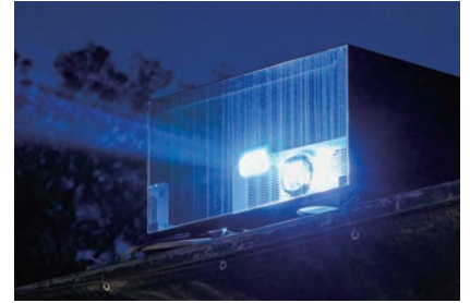
▲堀を挟んだ石垣への投写は光量が必要なため、12000 lmの明るさを誇るPT-RZ120JLWが4台採用された
