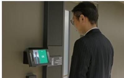
◀2つの入り口に設置されたチェッカーは照明を落とした廊下でもスピーディに反応し、認証と連動して自動ドアが開閉する。
