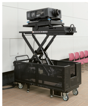
▲20000lmクラスのPT-DZ21K2Jは特注の移動式架台に設置して使用
