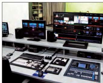
▲収録スタジオ内に、スタジオモニターとしてフルハイビジョン液晶ディスプレイを導入。プロンプターとセットして、コンパクトに設置している。
