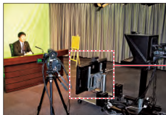
▲収録スタジオ内に、スタジオモニターとしてフルハイビジョン液晶ディスプレイを導入。プロンプターとセットして、コンパクトに設置している。
