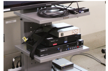
HDコム本体とデジタル入力レコーダーをつないで 会議収録が可能
