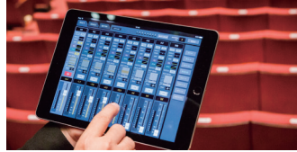
タブレットを用いて客席エリアでデジタルコンソール(オーディオミキサー)を操作
