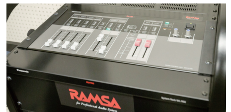
効果機器卓に設置されたデジタルミキサー操作ユニット WR-PU100
