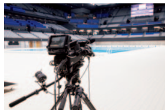
▲ドリーに乗せたスタジオカメラ。プールサイドを柔軟に移動して撮影が可能
