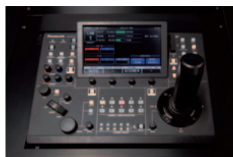
▲両アリーナに設置された合計5台のリモートカメラを制御するリモートカメラコントローラーAW-RP150GJ
