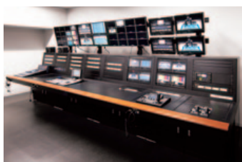
▲コントロールルームの様子。映像確認用モニターは最大16分割のマルチビュー表示が可能
