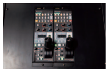
▲スタジオカメラの各種機能を操作する2台のリモートオペレーションパネルAK-HRP200G
