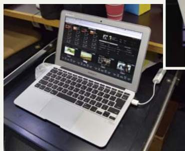
P2SSの端末と別の場所にある タブレットやノートパソコンでも取材 映像をコントロール可能
