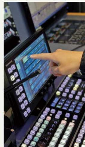
タッチパネル式のメニューパネルにより直観的な操作を実現
