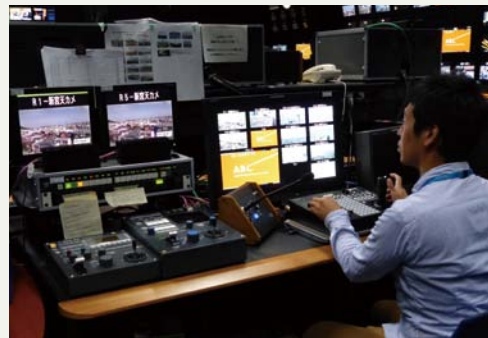
リモートカメラコントローラー AW-RP120Gを使用してNサブからカメラ制御
