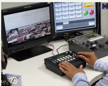
リモートカメラコントローラー AW-RP50を使用して回線センターからもカメラ制御
