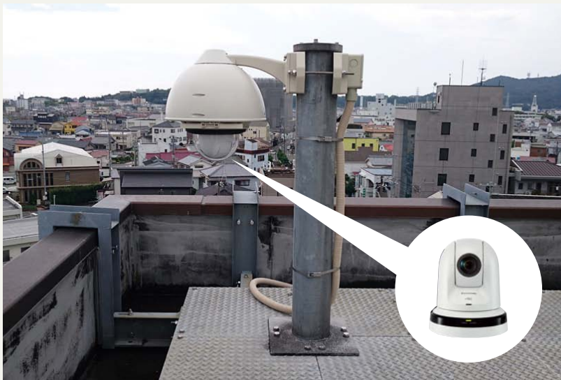
ハウジングに格納し、新宮支局屋上に設置された4KインテグレートドカメラAW-UE70W
