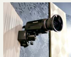
全景撮影用に壁面設置されたコンパクトカメラヘッド
