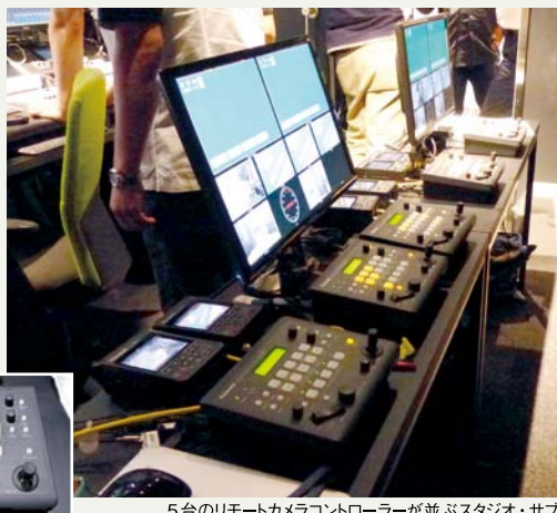
5台のリモートカメラコントローラーが並ぶスタジオ・サブ
