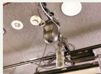
天井吊り下げ設置による歪みのない俯瞰撮影を実現
