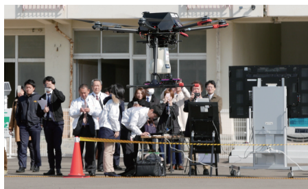
Jアラート受信機からのメールをトリガーとしてドローンが自動で出動
