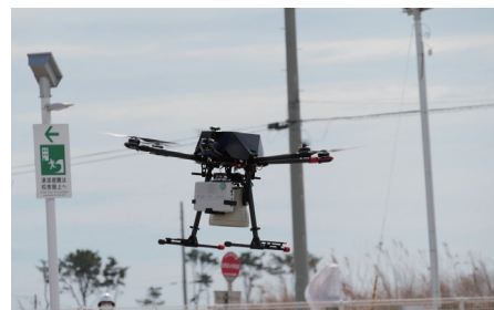
防災行政無線受信機とスピーカーを搭載して飛び立つドローン
