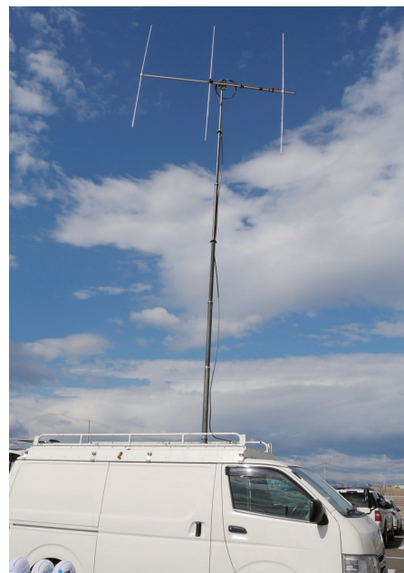
防災行政無線設備（実験局）の移動用親局設備
