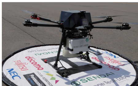
パナソニックの防災行政無線の受信機を搭載したドローン
