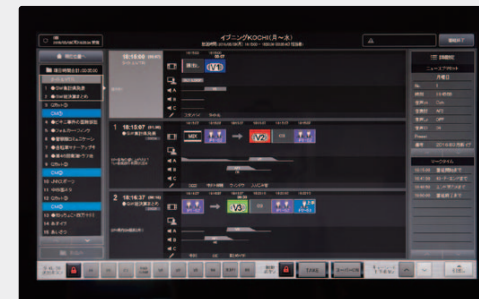
番組進行と連動したOPT画面。右サイドには次のアクションまでの残時間を表すマークタイムを表示。下部には物理ボタンと同じ各種アイコンも配置。また、再掲列が追加され、再播モニターを使用したスタジオ内の演出も、OTCから制御可能。
