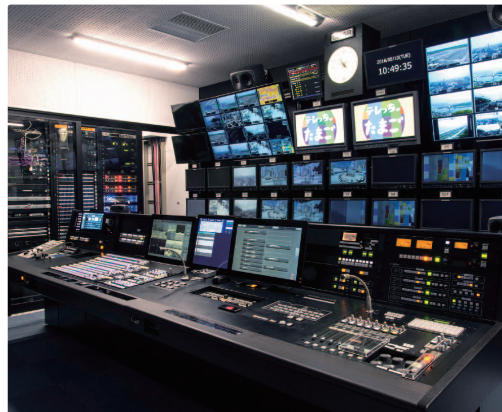
OTCシステムとライブスイッチャー AV-HS7300を軸に構成されたニューススタジオサブ
