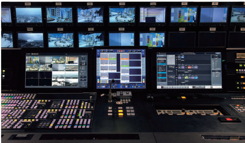
全体把握しながら操作ができる様に操作フロアを見直し、シンプルな使いやすさを追求したOTCシステム。OPT画面内へもTAKEボタンを搭載し、物理的なTAKEボタンの万一の故障に対応
