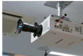
▲ゼロオフセットでの超短焦点投写を可能にするET-DLE020を装着したPT-RZ870JLW
