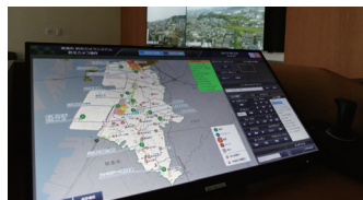
マップ上の防災カメラにタッチするとその画像を確認できる映像操作端末
