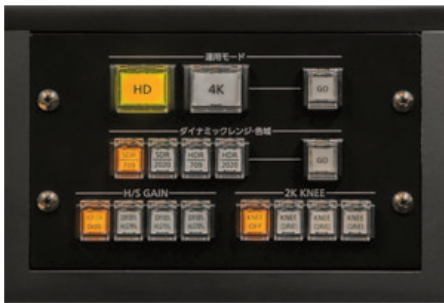
▲4K/HDはもちろん、ダイナミックレンジや色域などを一括で変更可能なモード選択ボタン
