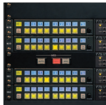
▲ 4MEのうち1列をME0(ゼロ)として加工演出用に使用。エフェクトやスーパー加工用に、D卓前にA/BバススイッチとTAKEボタン、そして2系統のキーヤーを備えた簡易パネルを設置した
