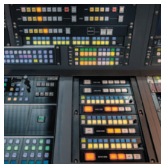
▲ 4MEのうち1列をME0(ゼロ)として加工演出用に使用。エフェクトやスーパー加工用に、D卓前にA/BバススイッチとTAKEボタン、そして2系統のキーヤーを備えた簡易パネルを設置した
