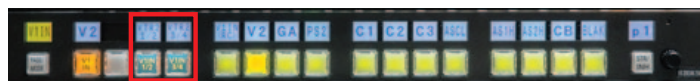
▲ 音声バスを表示させ、映像に連動して音声切り替わっていることを確認
