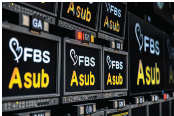
▲ モニターの素材名表示は電光文字ではなく、素材名が書かれた透明フィルムを挟み込む形にした。見やすいフロント選びにこだわり、黒いフィルムをもう1枚差し込むことで表示の明るさも調整している
