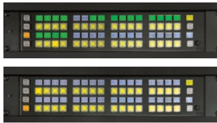
▲アサインパネルの素材名部分は4K素材/HD素材でバックライト色が変わり、視認性を向上させている。4K素材が緑色、HD素材が薄紫色に点灯する
