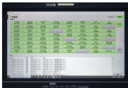
▲システムPCにはアラームロガーアプリも実装。万が一の機器異常時はGUIで障害発生機器の特定と状態監視が可能。アラームはAサブ内に設けたパトランプやブザー、そしてBサブへも連動して通知する
