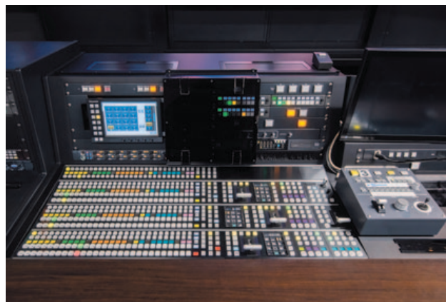
▲AサブのライブスイッチャーAV-HS7300(54入力×28出力)
