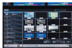
▲C-OTCの操作画面。左に番組一覧、右に16面の操作画面が表示されている。タッチパネルでCUT、MIX、WIPEも操作可能
