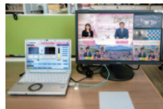
▲総務フロアの操作パソコン。左がマルチビジョンのシステム操作画面、右はレビュー画面
