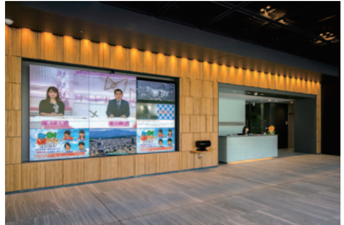
▲秋田放送様のエントランスに設置された9面マルチディスプレイ(TH-55VF2HJ×9台)
