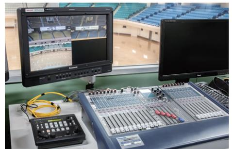
▲写真左:アリーナに設置されたHDインテグレートドカメラをコントロールするリモートカメラコントローラーAW-RP50と、映像確認用モニター
