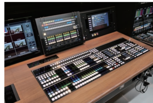
▲標準でDSKが4系統装備され、ニュース番組でも使いやすいAV-HS7300
