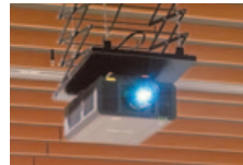
▲利用に合わせて電動で昇降する3チップDLPプロジェクターPT-RQ13KJ
