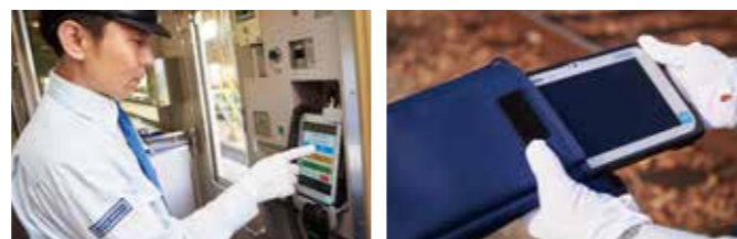
車掌の乗務ごとに、車掌室で放送用のプラグと接続して放送を実施。 オリジナルのキャリングケースに入れて車掌が持ち運び。
