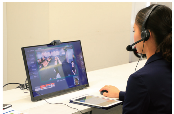
▲モニター上部のカメラでオペレーターの口の動きや表情を読み取りアバターに反映
