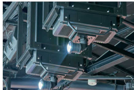
▲超短焦点レンズET-D3LEU100によって近距離での投写を実現
