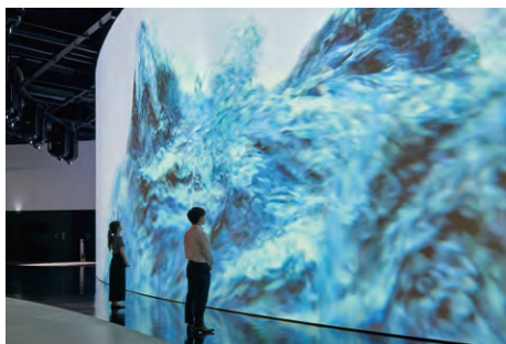
▲超短焦点レンズの使用によって、人が壁面に近づいても影が映り込まず、DLP®方式のドットの少ない美しい映像が間近で楽しめる
