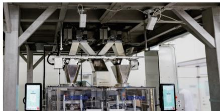
食品の自動充填・包装を行う機器には動作監視用のネットワークカメラを設置
