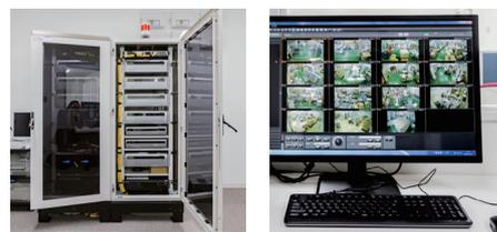
事務所に設置されたネットワークディスクレコーダー。全 268TB (テラバイト) の大容量で 180 日分 (工場外 90 日分) の全モニタリング映像を記録している (左) 全映像記録は PC 上で簡単な操作によって閲覧可能 (右)
