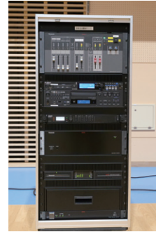
▲移動型音響操作ワゴンに収納されたデジタルミキサーWR-DX100(中段)とミキサー操作ユニットWR-PU100(上段)
