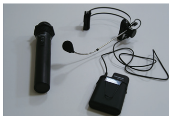
▲ボルダリング室で用いられるインストラクター用の1.9 GHz帯デジタルワイヤレスマイクシステムWX-SR200Aシリーズ
