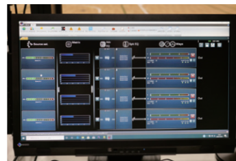
▲高性能DSP内蔵のデジタルアンプWP-DM900シリーズを設定するソフトウェア
