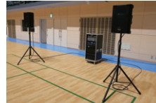
▲移動型音響操作ワゴンと30cm2ウェイスピーカーWS-AR200-K
