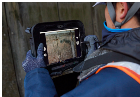
FZ-G1の内蔵カメラで変状を撮影。デジタルカメラを持ち歩く必要がなくなり、データ整理の手間も削減。
