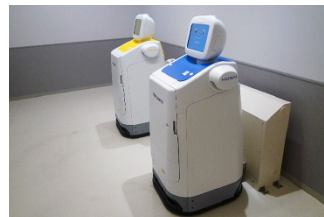
▲稼働前・後は所定の充電器で待機。2.5時間の充電で7時間稼働可能
