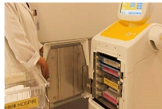
▲庫内の収納スペースは327 × 446 × 390 mm (凸部含まず)。引き出し型のトレイに収納可能
