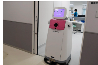
▲自動ドアも簡単に通過可能。ガイドラインの敷設なども不要で、新築病院でなくても導入が簡単
