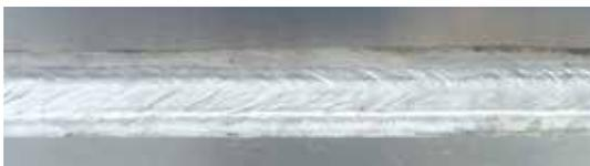
電流/電圧：170 A/20.8 V 速度：0.8 m/min
