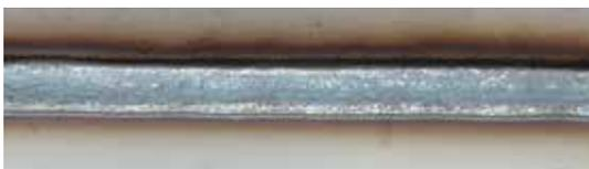
電流/電圧：200 A/21.6 V 速度：0.8 m/min
