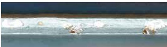
電流/電圧：300 A/29.6 V 速度：0.8 m/min
