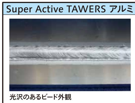
溶接条件) 材質：A5052 継手：T継手 溶接電流：155 A 溶接速度：60 cm/min 板厚：t3.0 mm
