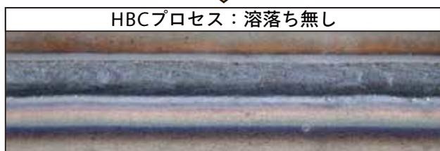
溶接条件) 継手：重ね ガス：MAG
