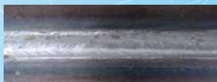
【CO<sub>2</sub>, SPCC 板厚3.2 mm, 320 A, 110 cm/分, 重ね継手】
