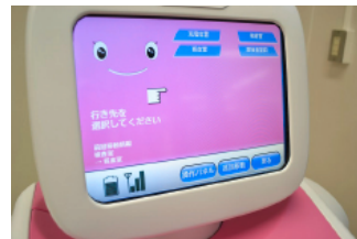
▲行き先はディスプレイをワンタッチ。あとは自動で自律搬送。
