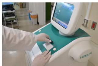
▲収納庫の開閉はIDカードによる認証でセキュリティを確保。履歴は簡単・正確に管理可能。
