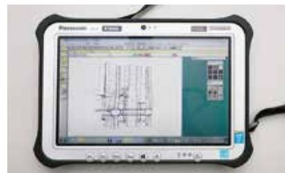
サーボトータルステーション(写真上)やGNSS(写真左下)と連動して、現況測量などで活躍。測点を割り出す際も、タッチペンで画面をタップするだけで位置を取得。(写真右下)取得した位置情報を元に、FZ-G1の画面上でCAD図面の編集が可能。
