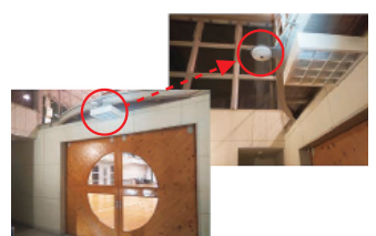
▲避難所に来た人数をカメラがカウントして防災対策室へ通知。適正量の支援物資の配分が可能。
