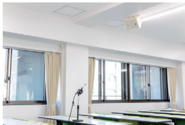
▲PASDによる音響シミュレーションの様子。スピーカーに向けた測定用マイクでテスト信号を集音
