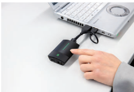
▲メインボタンで画面共有を開始。端のサブボタンを押すと最大4画面のマルチ画面に変更できる
