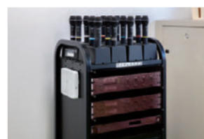
▲2020年にリニューアルされた「清心館」ではWX-SR200Aシリーズの受信機・アンテナ・16本のマイクホロンを可搬式ラックに収納。DECT準拠方式なので別の教室へ移動して使用することも可能
