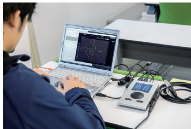
▲マイクで測定した結果をもとに、位相を崩さず目標特性に近づくようFIR係数を自動で算出する
