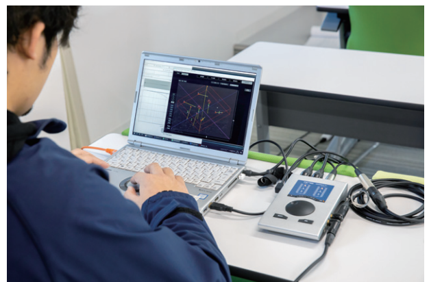
▲マイクで測定した結果をもとに、位相を崩さず目標特性に近づけようFIR係数を自動で算出する
