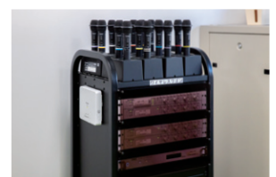
▲2020年にリニューアルされた「清心館」ではWX-SR200Aシリーズの受信機・アンテナ・16本のマイクホルンを可搬式ラックに収納。DECT準拠方式なので別の教室へ移動して使用することも可能
