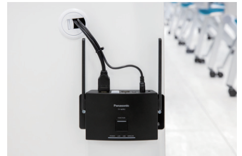
▲教卓の端に設置されたPressITの受信機。1台の受信機で最大32台の送信機に接続可能
