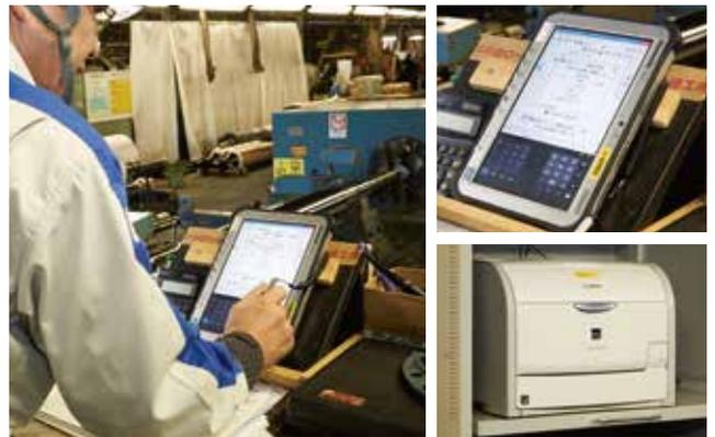
TOUGH PAD を機械の操作台に1台ごと設置し、検査結果を即座にタッチペンで入力。正確な入力とプリンターとの連携で検査成績表発行業務を効率化。
