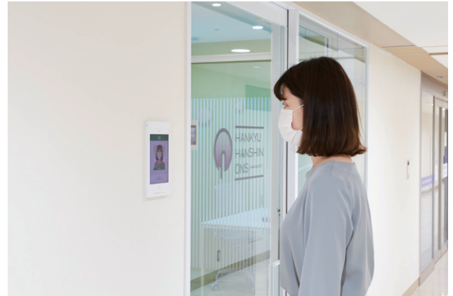
▲施設の出入口で顔認証による入退管理を実施
