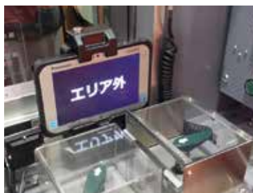
運転台後方に取り付けたTOUGHPADの様子。 通常運行時は「エリア外」表示。
