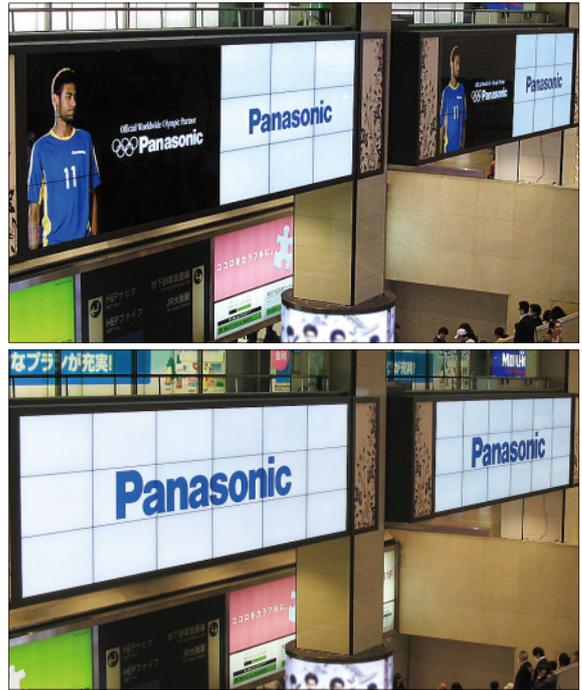
▲「梅田ツインビジョン」での表示例。1基のマルチスクリーンシステムを2画面で使用(上写真)することも、32:9のワイド画面として使用(下写真)することもできる。
