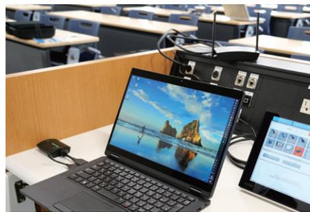
▲実習室に導入されたワイヤレスプレゼンテーションシステムPressIT。PCに挿してボタンを押すだけで、PC画面をプロジェクターやディスプレイに表示。コンパクト設計で別の教室へも持ち出して使用可能
