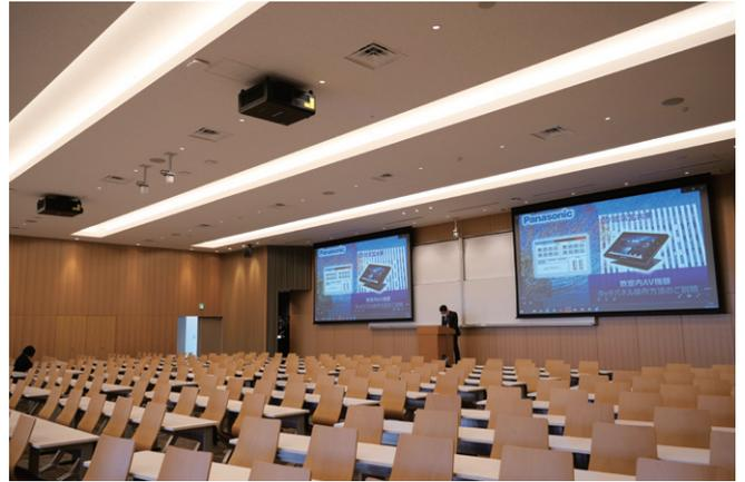
▲ブラックスクリーンを左右2面設置し、3チップDLP®レーザープロジェクターPT-RZ21KJを使って投写する大講義室。音響にもこだわり、高音質なRAMSAアレイスピーカーと天井スピーカーを導入している
